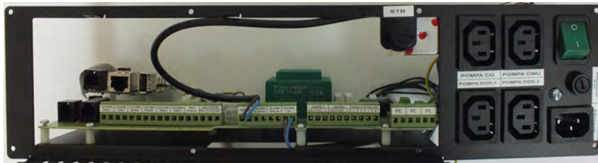
Rysunek 1 Listwa przyłączeniowa do zasilania urządzeń regulacyjnych
