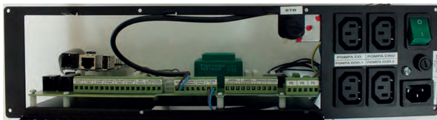
Rysunek 2 Listwa przyłączeniowa do zasilania urządzeń regulacyjnych (uwaga fot. przedstawia przykładowe rozmieszczenie podłączeń, szczególnie w dołączonej DTR sterownika).
