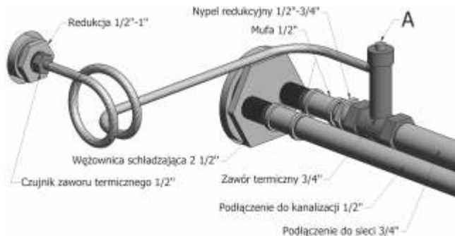
Rysunek 6. Sposób podłączenia termicznego zabezpieczenia odpływu.
