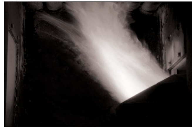
Rysunek 14. Prawidłowy wygląd paleniska przy spalaniu węgla.
