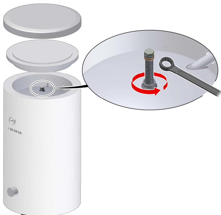
Rys. 8 Wymiana magnezowej anody ochronnej
