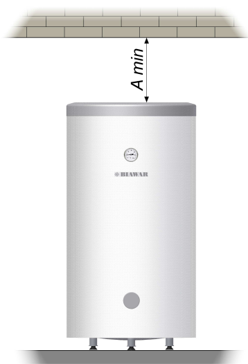
Rys. 4 Minimalna odległość do obsługi/wymiany ochronnej anody magnezowej
