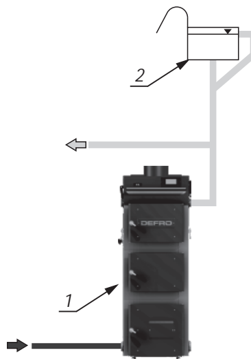
Rysunek 6. Przykładowy schemat zabezpiecze kotła AKM: 1-kocioł; 2-otwarte naczynie wzbiorcze.
