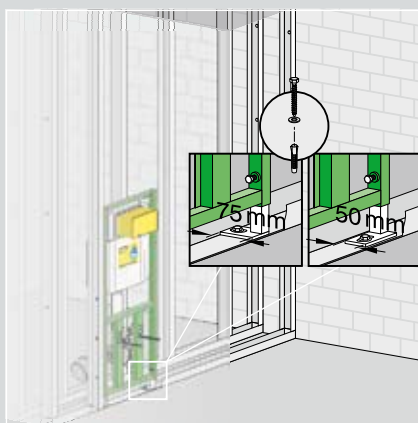
Montaż na szkielecie konstrukcyjnym
