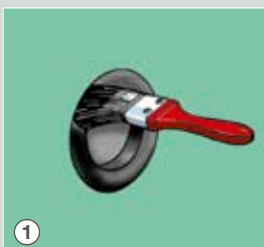
1 Brzegi otworu zabezpieczyć środkiem gruntującym.
