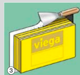
3 Krawędzie wypełnić masą szpachlową.
