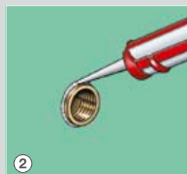
2 Uszczelnić szczelinę wokół przyłączy wody.
